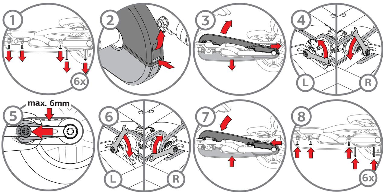
Spannung der vorderen Kette:
